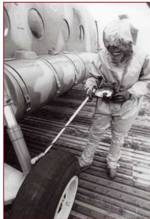
Аэродром Малейки. Дезактивация вертолета и проведение дезометрического контроля
